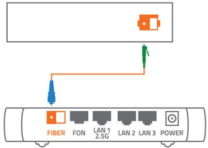
Diese Information ist nur relevant, wenn du einen **eigenen Router** nutzt und bereits einen **passiven ONT** hast.
